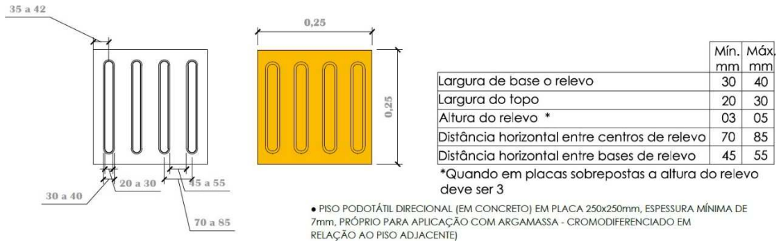
Figura – Sinalização tátil de direcional – Modulação de piso
