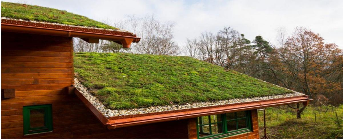
**Figura 1** - Telhado verde. Fonte: Bigstock (2018).
