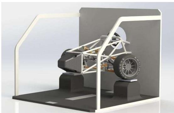
**Figura 14** – Protótipo Virtual 3D da Bancada Didática.
