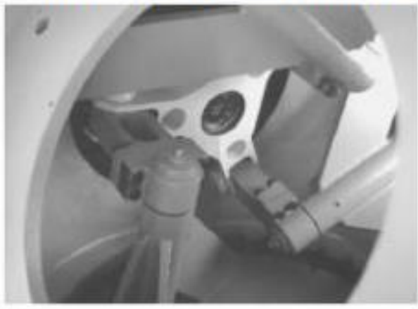
Controle de passo da pá com um único atuador
