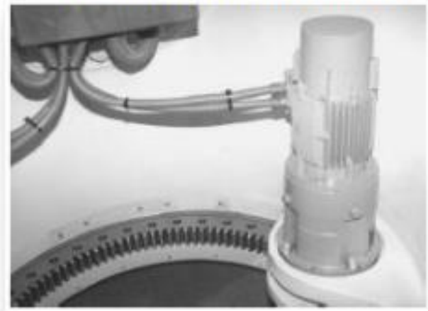
Controle de passo da pá com atuador individual
